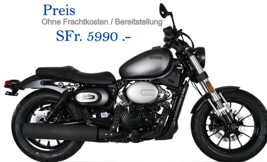
MOTOR 60° V2-Motor, Viertakt-OHC, 4 Ventile pro Zylinder, 296 ccm, wassergekühlt
